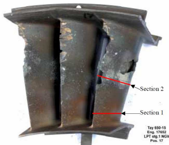
Figura 6 – Estatora do primeiro estágio da turbina LP mostrando as posições dos cortes transversais feitos para exame (Fonte: Technical Report n° EFI/0469 da Rolls-Royce)
