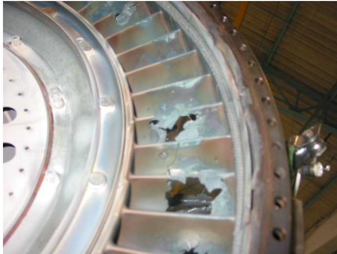
Figura 3 – Estatoras (NGV) do 1º estágio da turbina de baixa pressão (LP).
