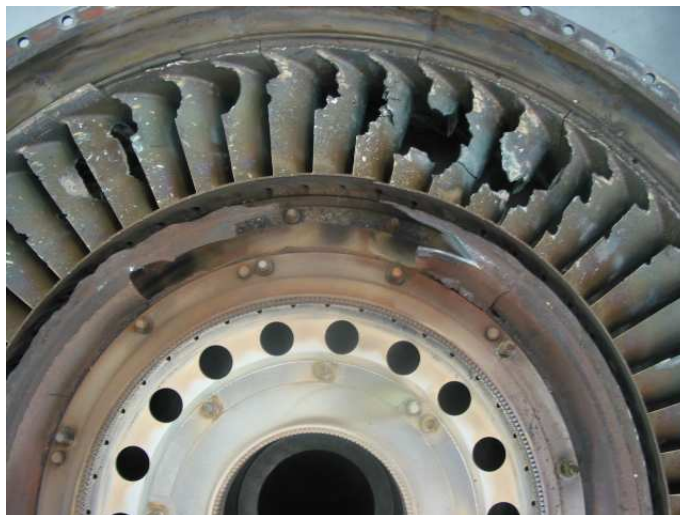
Figura 4 – Detalhe da área de perda de material do selo do duto de arrefecimento.
