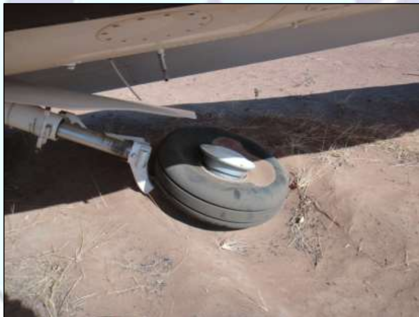
Figura 3 – Pneu do trem de pouso principal esquerdo vazio.
