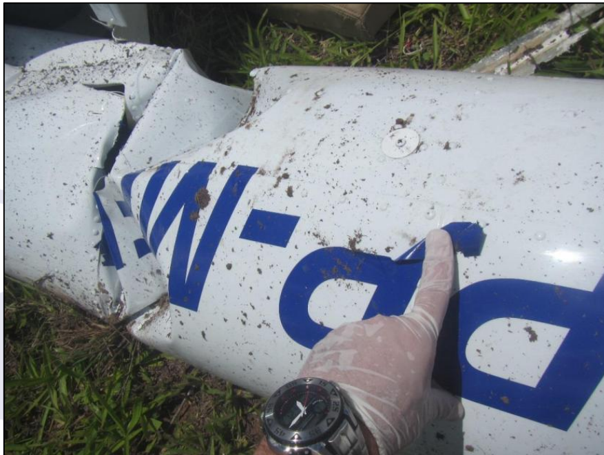
Figura 2 - Matrícula da aeronave adesivada com marcas de outra aeronave.
