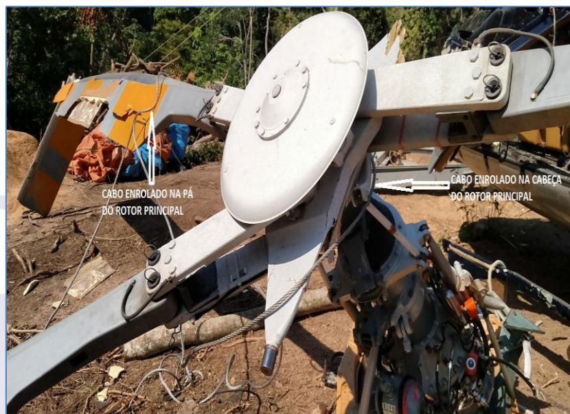
Figura 3 - Cabo de aço enrolado na pá e na cabeça do rotor principal.
