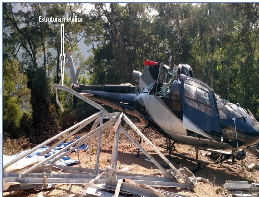
Figura 1 - Vista da aeronave após o impacto, com destaque para a estrutura metálica onde houve a colisão do rotor principal.
