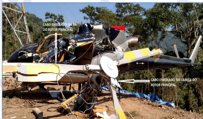
Figura 2 - Cabo de aço enrolado na pá e na cabeça do rotor principal.
