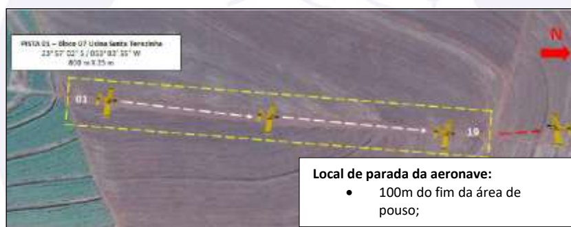
Figura 3 - Vista da trajetória percorrida pela aeronave na tentativa de decolagem da área de pouso do bloco 07 da Usina Santa Terezinha.
