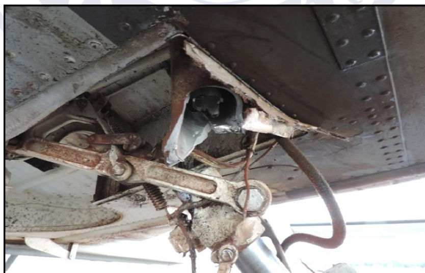
Figura 3 - Vista da fratura no trem de pouso esquerdo.
