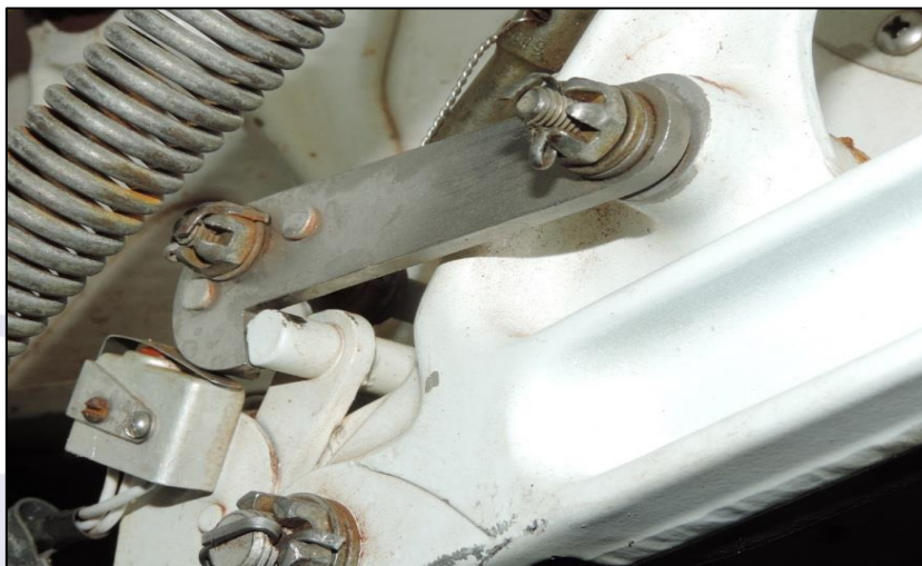
Figura 3 - Trava da perna do trem principal esquerdo.
