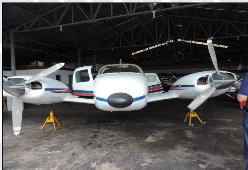
Figura 2 - Recolhimento normal do trem de pouso.
