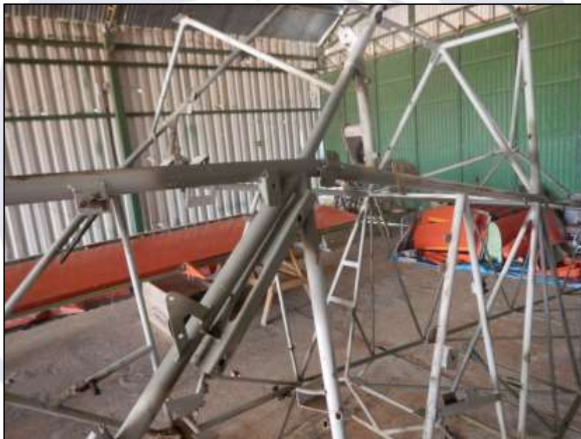
Figura 4 - Parte da estrutura da aeronave com marca de reparo.
