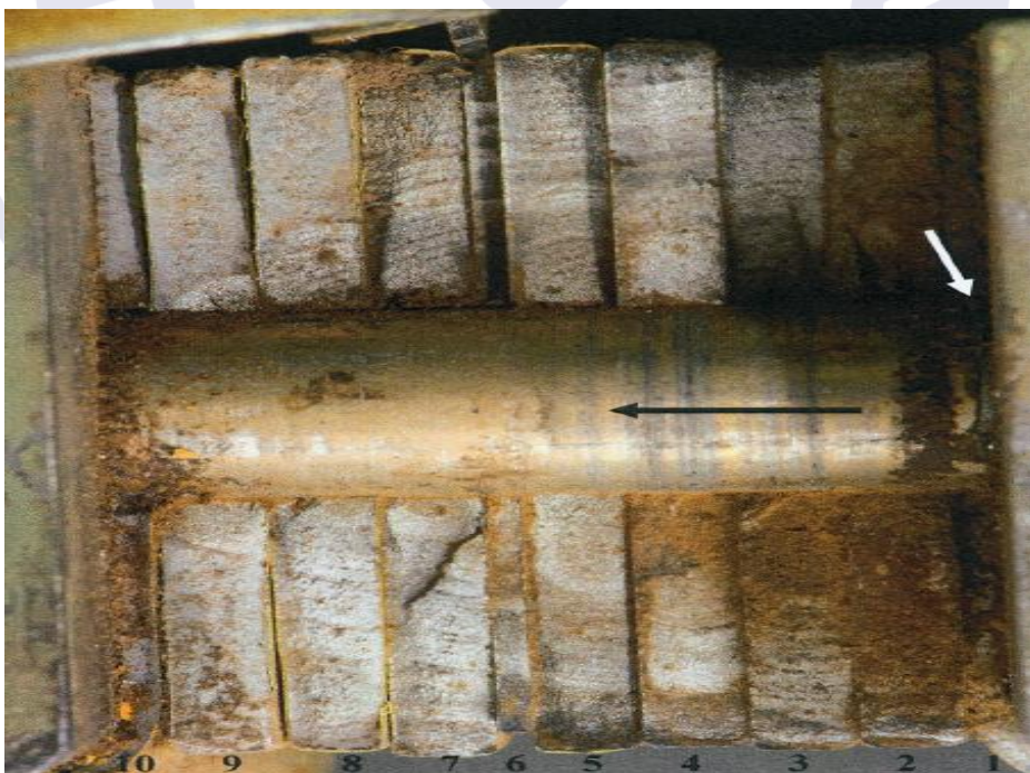
Figura 3 - Detalhe da fratura por fadiga das chapas inferiores da asa esquerda do PT-UKT. As trincas foram iniciadas em cada chapa interna na região de contato com o parafuso (seta branca). A propagação ocorreu da chapa 1 para chapa 10 (seta preta).
