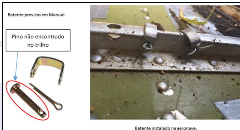
Figura 7 - Detalhe do batente Previsto / Instalado na aeronave.
