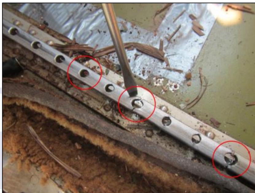
Figura 4 - Estado dos trilhos de travamento do assento do piloto.
