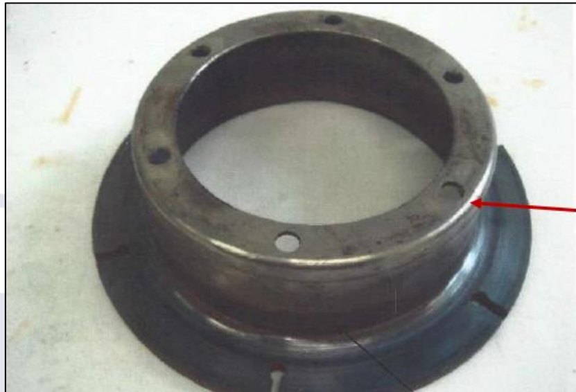
Figura 5 - Azulamento na pista do disco de freio.
