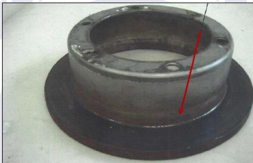
Figura 6 - Corrosão superficial no disco de freio.
