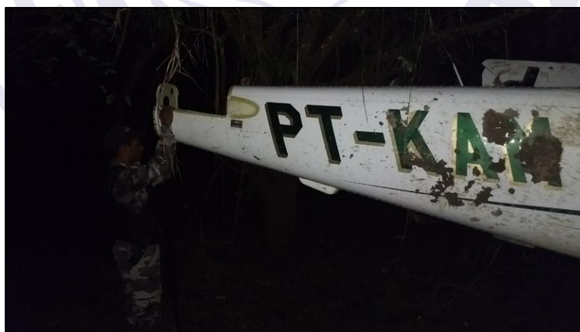
Figura 2 - Aeronave sem a empenagem.
