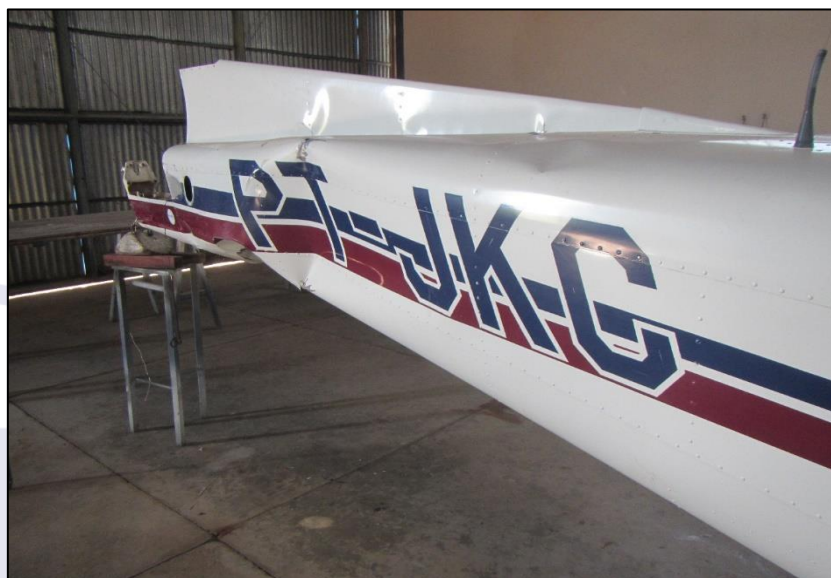
Figura 3 - Danos à aeronave.
