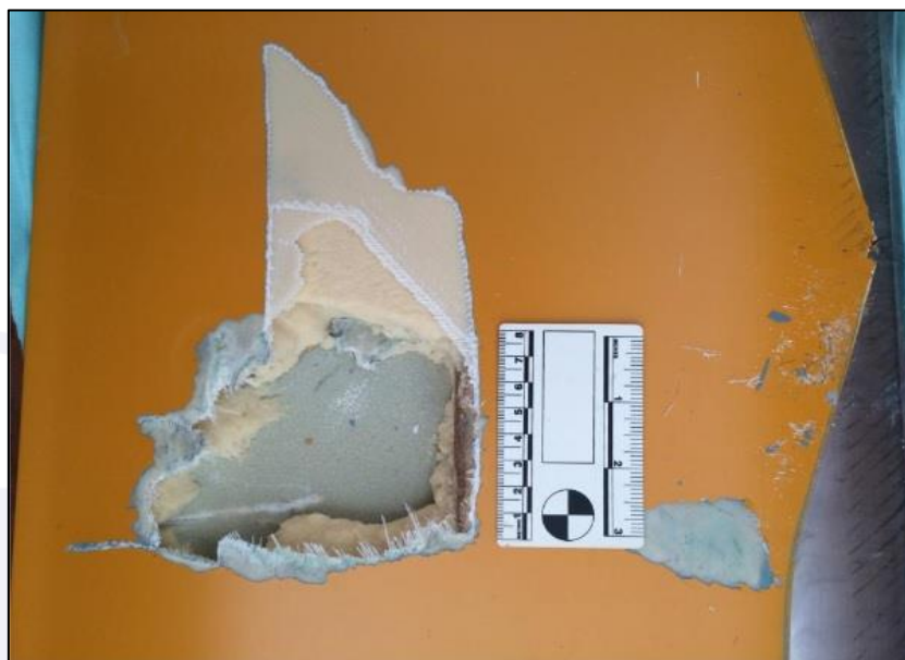
Figura 2 - Dimensão dos danos no extradorso da pá.
