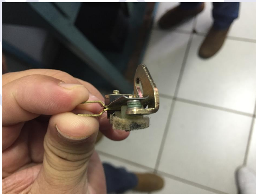
Figura 3 - Coloração esverdeada no magneto que falhou.
