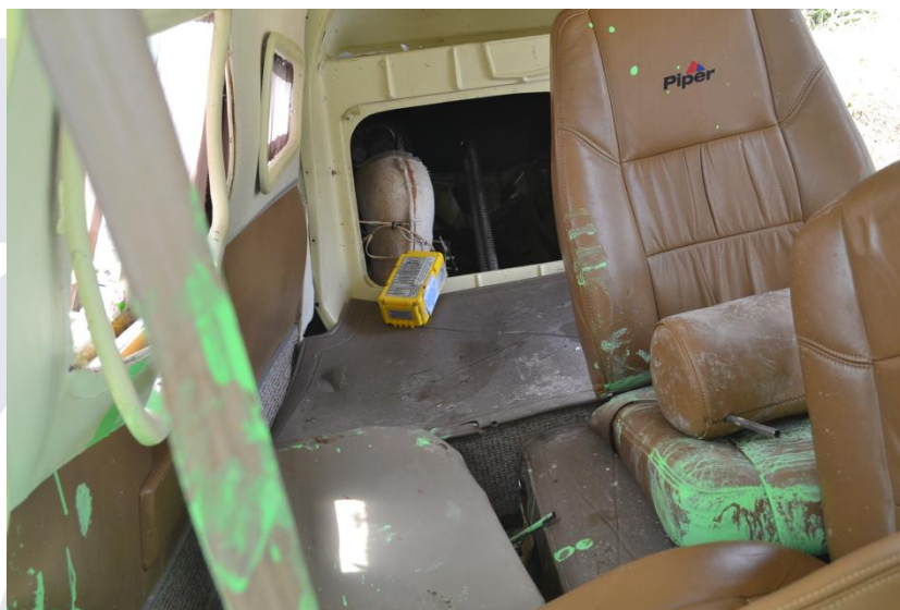
Figura 1 - Resíduos de tinta da carga transportada na cabine de passageiros.
