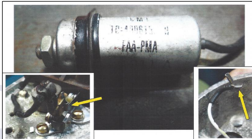
Figuras 2 - Capacitor do Magneto Direito: A) Parte do terminal do capacitor que ficou no pino, e B) outra parte na extremidade do fio.
