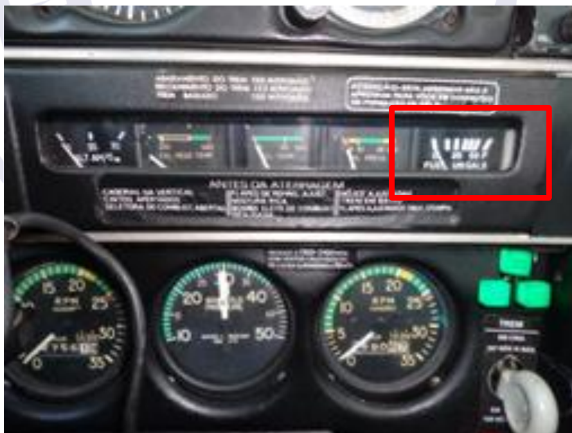
Figura 3 - Liquidômetros sem indicação com a aeronave energizada.
