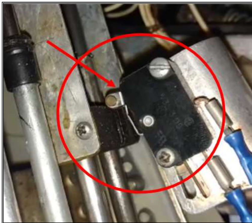
Figura 2 - Microinterruptor acionado pelo ressalto do manete de potência.
