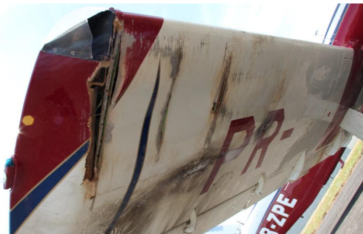
Figura 2 - Asa direita da Aeronave com marcas de fricção com asfalto e marcas de fogo (fuligem).
