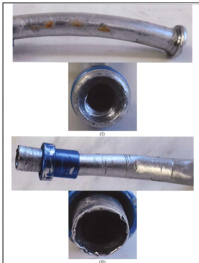
Figura 4 - Em (I), extremidade do tubo com a presença do terminal para ajuste cônico. Em (II), extremidade sem a presença do terminal.
