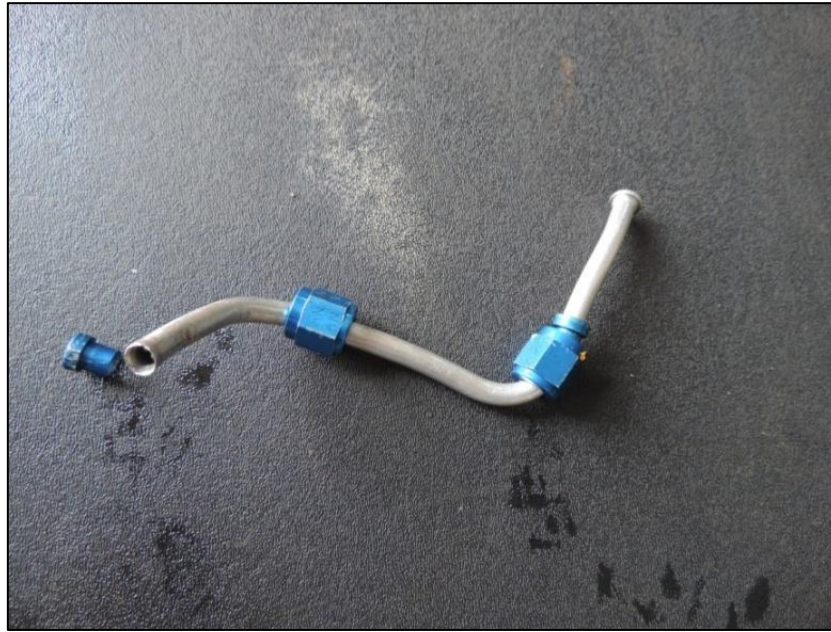
Figura 3 - Componente que apresentou vazamento durante o baixamento pelo sistema normal.
