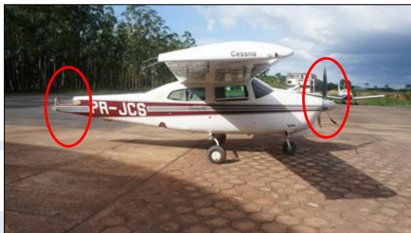
Figura 2 - PR-JCS sem a deriva e com as pás da hélice danificadas.
