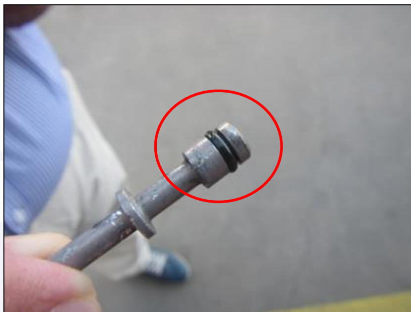
Figura 10 - Anel de vedação do tubo de transferência desgastado ( packing ).
