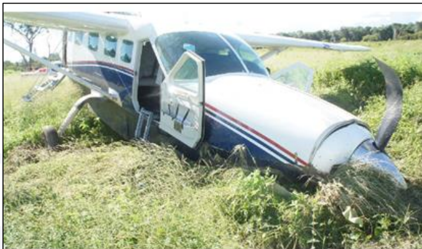
Figura 1 - Aeronave com o trem de pouso do nariz quebrado e danos na pá da hélice.
