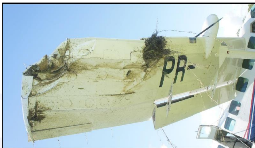
Figura 4 - Detalhe dos danos na asa direita.
