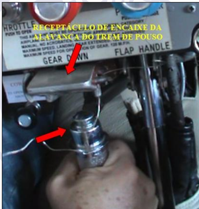
Figura 3 - Receptáculo de encaixe e alavanca de comando do trem de pouso da aeronave.
