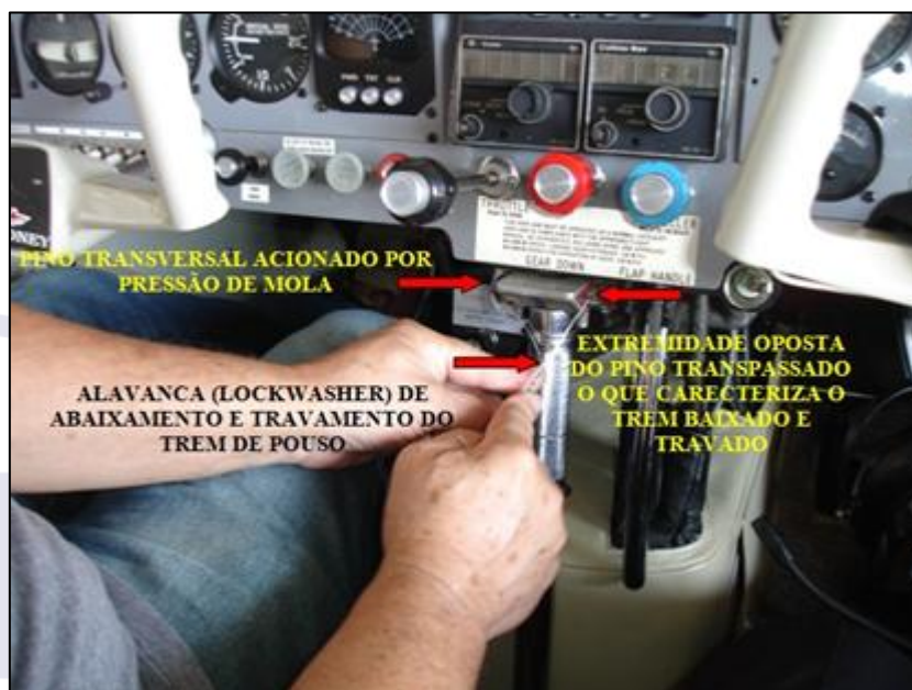
Figura 4 - Detalhes do baixamento do trem de pouso da aeronave.
