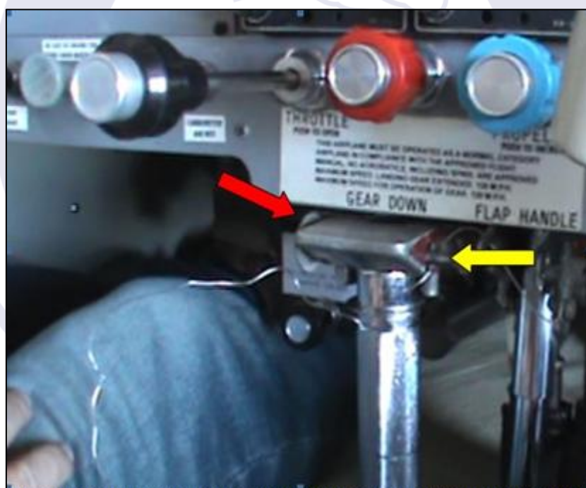
Figura 5 - Vista do pino de travamento com o trem de pouso baixado e travado.
