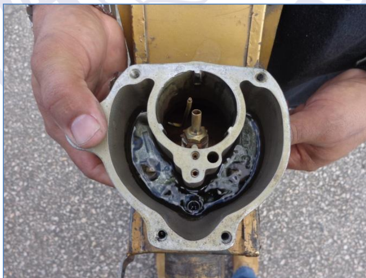
Figura 3 - Vista da cuba do carburador.
