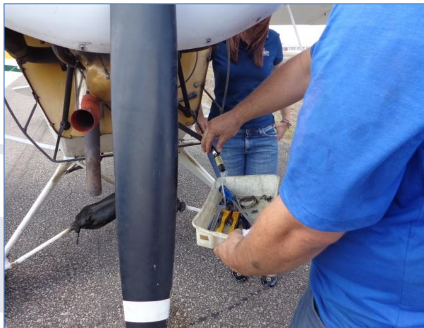
Figura 4 - Ventilação da linha de combustível.
