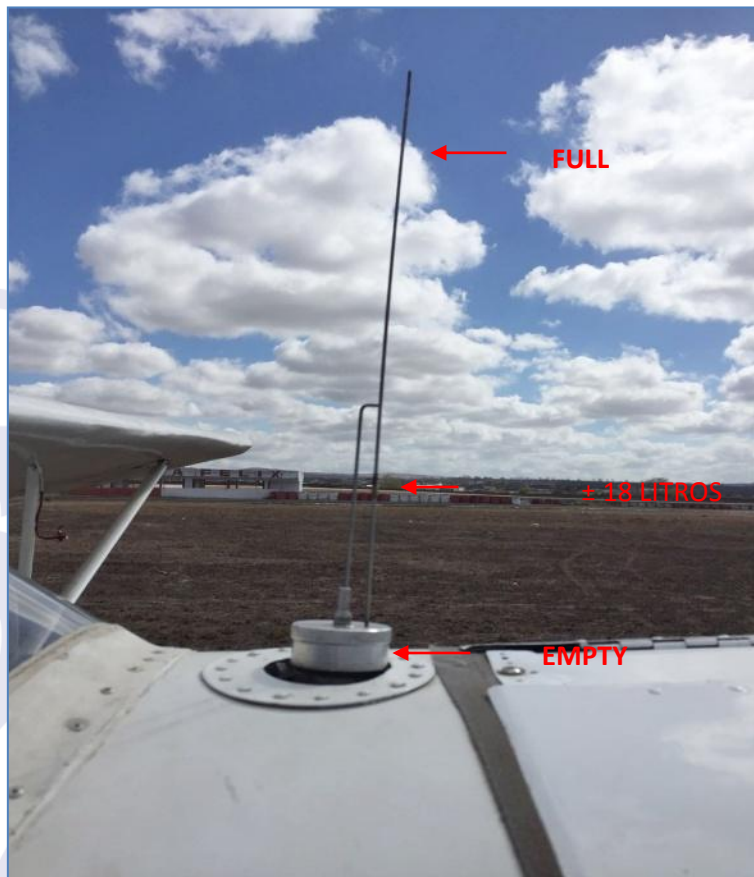
Figura 2 - Marcador da quantidade de combustível.
